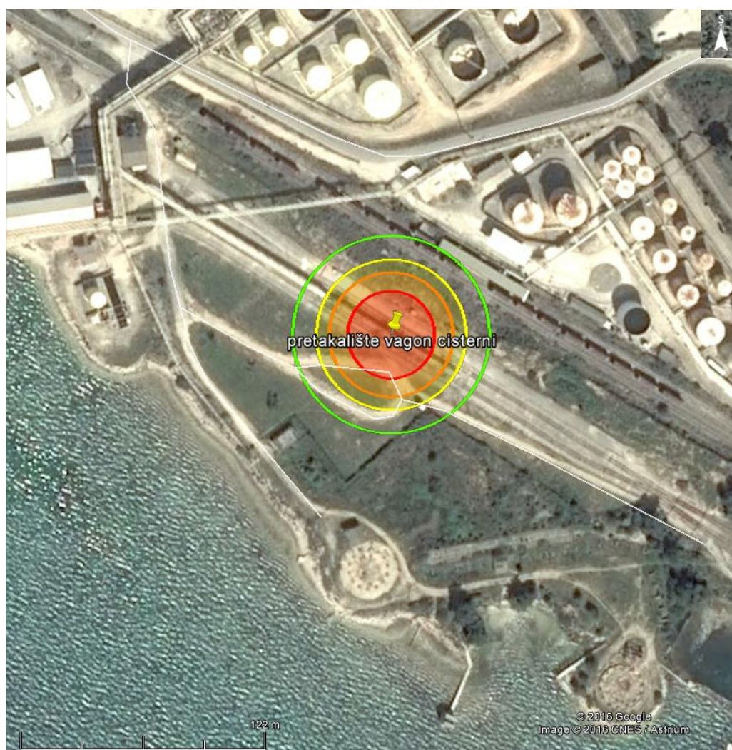
Slika 47. Zone ugroženosti uslijed zapaljenja benzina na lokaciji pretakališta vagoncisterni (punjenje 4 vagon cisterne istovremeno)
