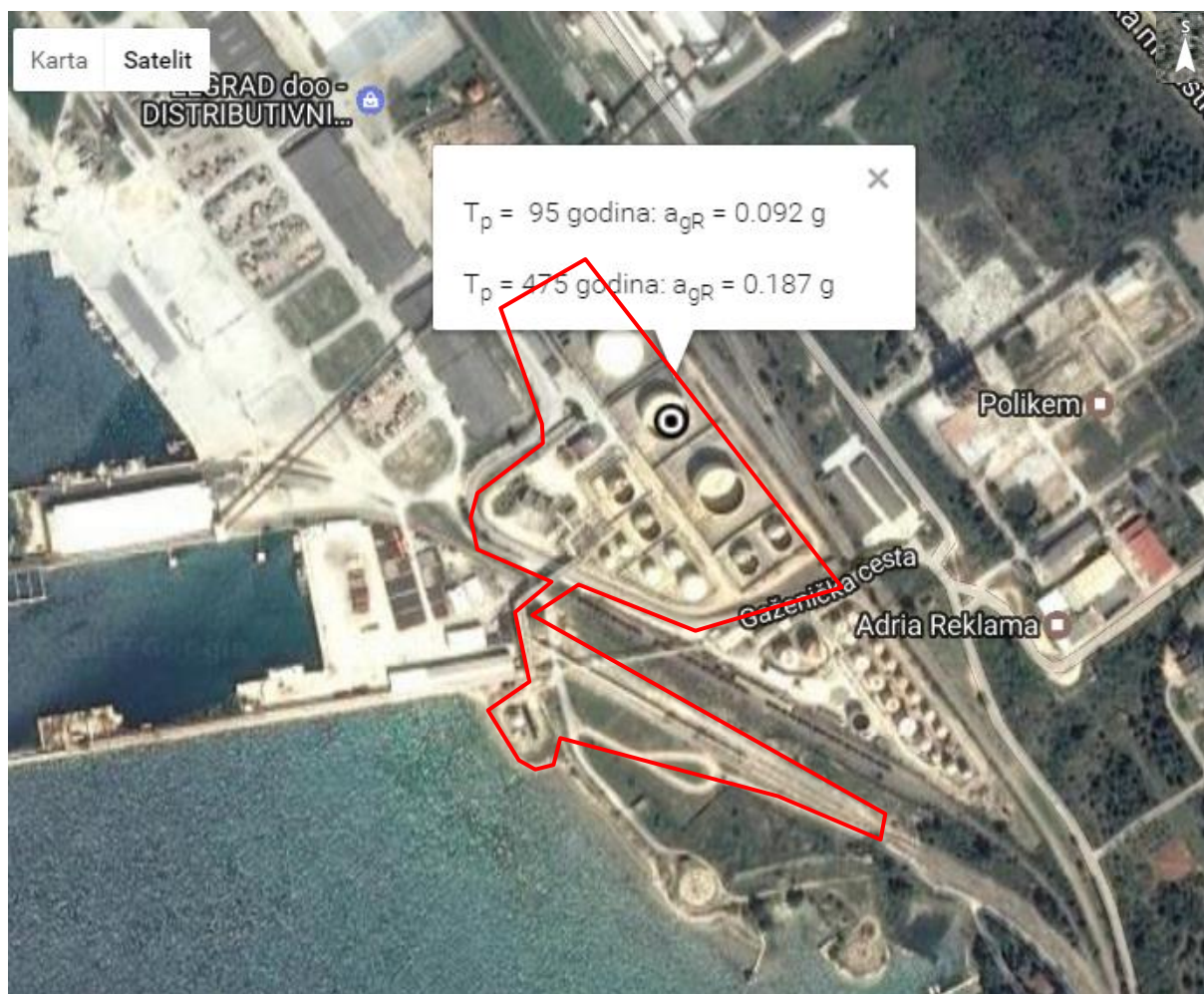
Slika 18. Iznosi vršnih ubrzanja tla za povratna razdoblja 95 i 475 godina za lokaciju TTTR
