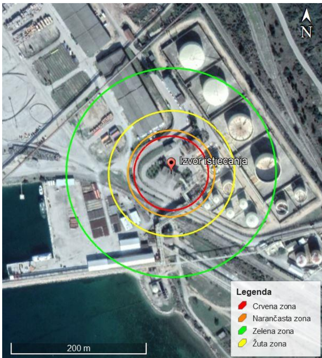
Slika 44. Zone ugroženosti uslijed eksplozije para benzina na lokaciji autopunilišta (punjenje 5 autocisterni istovremeno)
