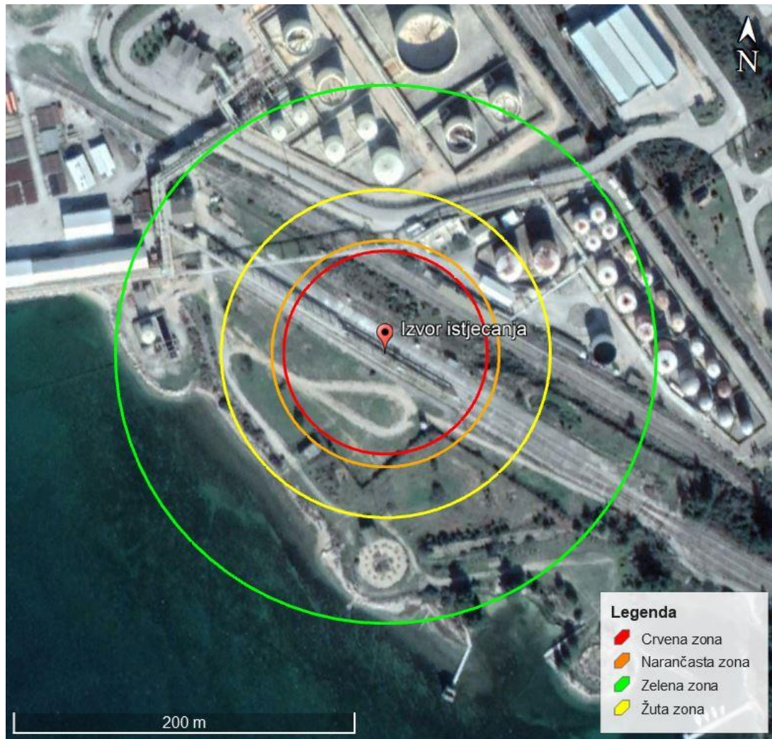
Slika 46. Zone ugroženosti uslijed eksplozije para benzina na lokaciji pretakališta vagon cisterni (punjenje 4 vagon cisterne istovremeno)
